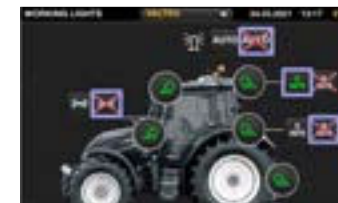
Es fácil configurar las luces de trabajo con la pantalla táctil de 9". Las luces de trabajo Premium y Premium+ también incluyen luces de esquina, que se controlan mediante un sensor de ángulo de rueda en el eje delantero.
