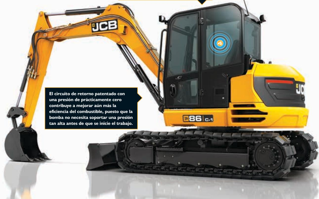
El circuito de retorno patentado con una presión de prácticamente cero contribuye a mejorar aún más la eficiencia del combustible, puesto que la bomba no necesita soportar una presión tan alta antes de que se inicie el trabajo.
