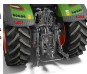
Elevador trasero con enganche rápido y cuñas (AU, Sudáfrica, Europa Oriental)
