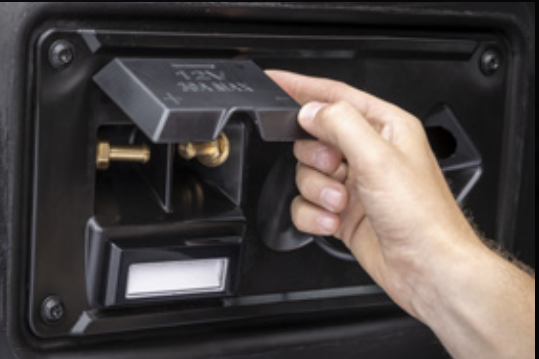
Con la opción del paquete profesional encontrará dos enchufes de 12 V integrados en el depósito de combustible para alimentar una bomba externa de combustible o de AdBlue®.
