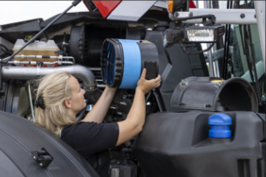
Se puede acceder al filtro de aire del motor y limpiarlo con mucha facilidad.
